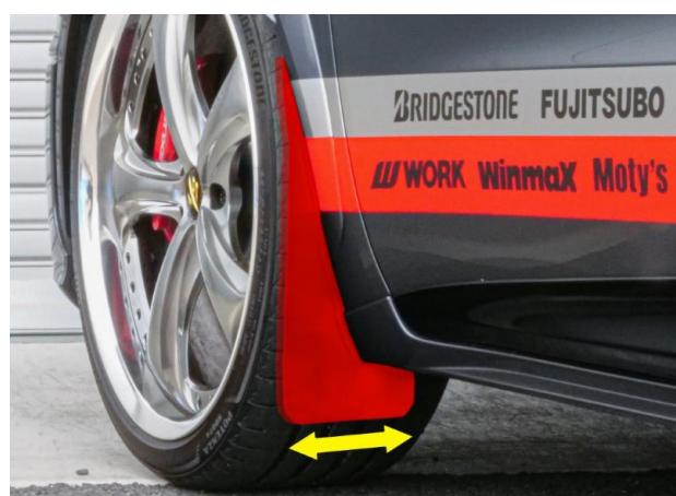
取付時の横方向のフラップ出しろ調整が可能（調整幅約5mm）
