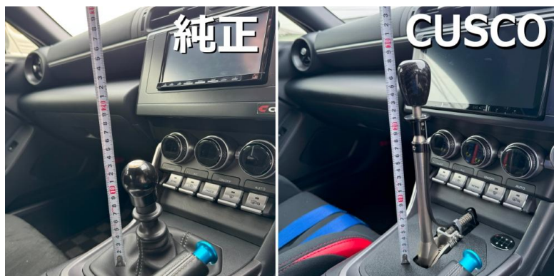
シフトノブ高さ比較 シフトノブ位置が純正より15cm前後高くなります
