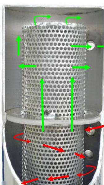
下图为，机油透气壶产品断面（显示部分过滤网）
