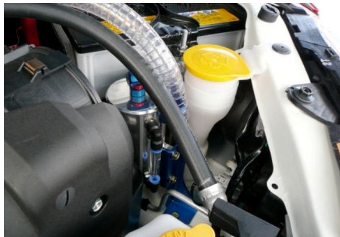
◇回流进气通道的废气通过透气油壶过滤处理，使不纯物质减少的气体再循环回发动机。防止燃料混合气体的再燃烧，防止发动机正常工作的低下。
