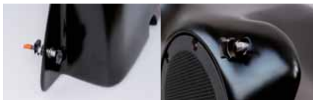
使用快装螺栓进行安装。参加赛事以及行驶赛道时可简单拆装。
