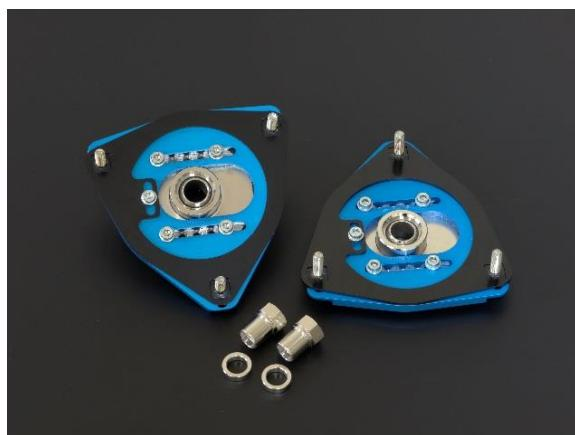
与以往的外倾角调整式金属不同，CC 金属波子塔顶可以独立调整外倾角（Camber），后倾角（Caster）。提供更广的调整范围。避震器无需卸下，可以在避震器安装好的情况下直接进行倾角调整。
