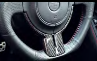
方向盘碳纤维件 商品编号：965 823 CS ●适用于原厂方向盘 & CUSCO 运动型方向盘
